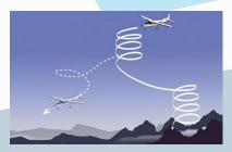
Espiral Mortal. El piloto durante un giro a la derecha o a la izquierda, tendrá sensación de giro hacia ese lado, si se continua mas de 20 s, el piloto experimentara la sensación de que la aeronave deja de girar, si en ese momento intenta nivelar, la sensación que tendrá será la de giro en sentido contrario, entrará en una situación de barrena de la que no puede salir y en perdida de altitud con grave riesgo de impacto contra el suelo.
