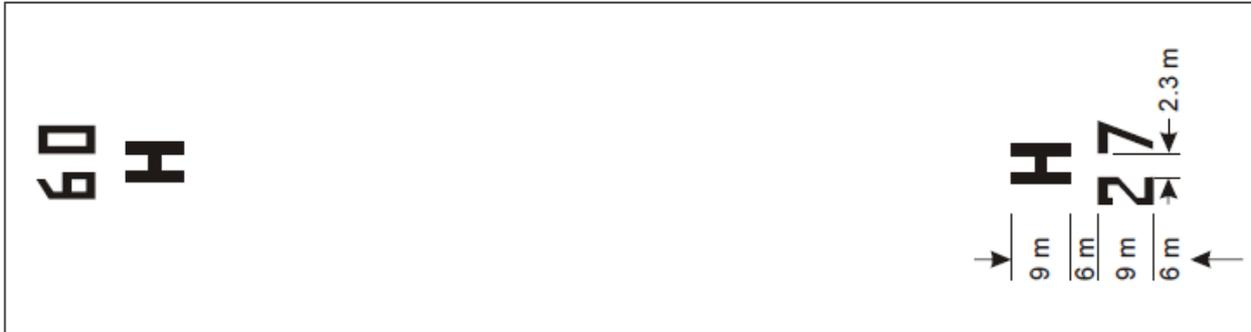
Figura 4.2.1.-2. Señal de designación de la FATO y señal de identificación de helipuerto para FATO de tipo pista de aterrizaje
