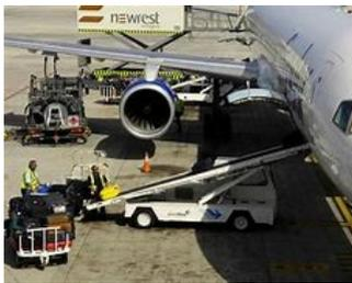
La atención a las aeronaves o handling de rampa incluye la estiba y carga en las bodegas tanto de equipaje como de mercancía, la limpieza de las aeronaves, el suministro de combustible, el deshielo o el guiado de las aeronaves en la plataforma.
