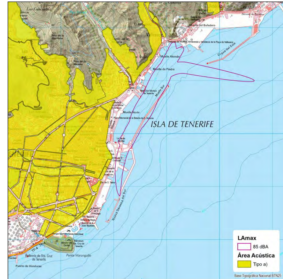
Ilustración 13. Isófona de 85 dBA L_{Amáx} . HASCTF. Fuente: Elaboración propia .
