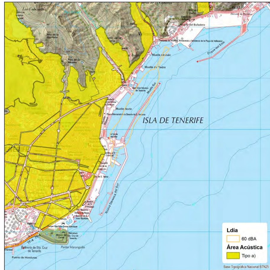
Ilustración 12. Isófona de 60 dBA L_d para el Desarrollo Previsible. HASCTF. Fuente: Elaboración propia .
