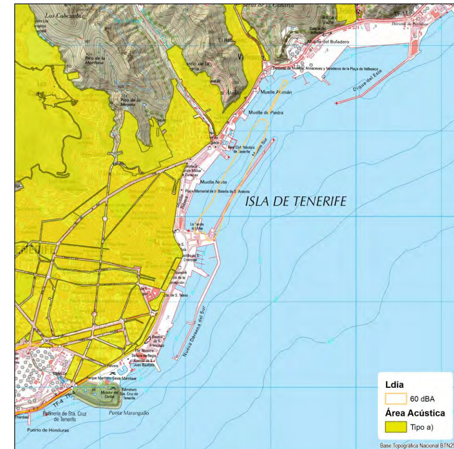
Ilustración 11. Isófona de 60 dBA L_d para el Tráfico Inicial Estimado. HASCTF. Fuente: Elaboración propia.
