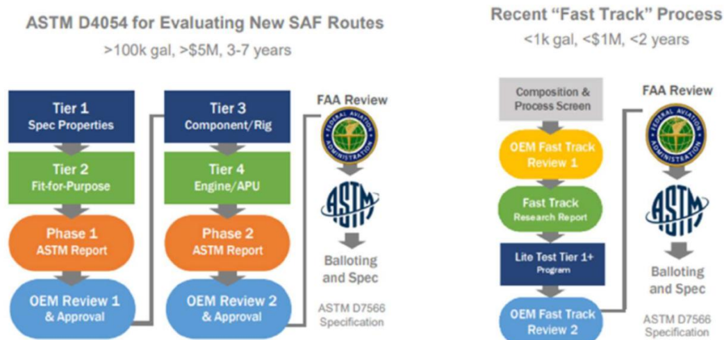
Figura 22 - Resumen esquemático de los procesos de certificación de rutas tecnológicas según la Norma ASTM D4054. Fuente: Technical Information Document #4, JIG, nov-23
