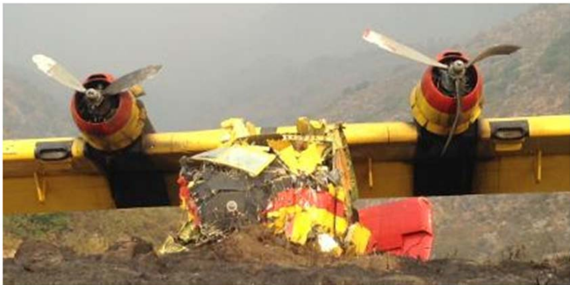
Figura 11. Imagen del estado de las hélices y cabina de la aeronave
