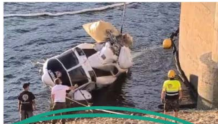
Bell 412 Embalse de Guadarranque (Cádiz) Alabeo repentino al introducir el helibalde en el agua
